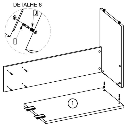
NA SEQUENCIA PARA FACILITAR A FIXAÇÃO DO TAMPO (1) NA ESTRUTURA, POSICIONE O TAMPO (1) NO CHÃO E FAÇA A FIXAÇÃO TOTAL DO PÉ PAINEL COM CONFORME DETALHE 6.
