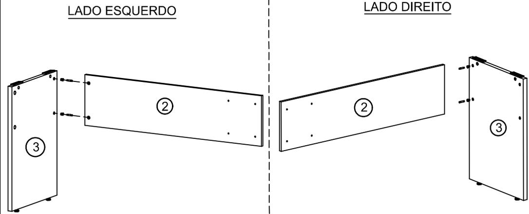
INICIE MONTANDO ESTRUTURA: NO PÉ PAINEL (3) DA MESA AUXILIAR CONTÉM FURAÇÃO, PARA QUE A MESA POSSA SER CONFIGURADA TANTO PARA O LADO ESQUERDO QUANTO PARA O LADO DIREITO COMO INDICAM AS IMAGENS, DEFINIDO O LADO, FIXE O PÉ PAINEL (3) AO PAINEL FRONTAL 2.
